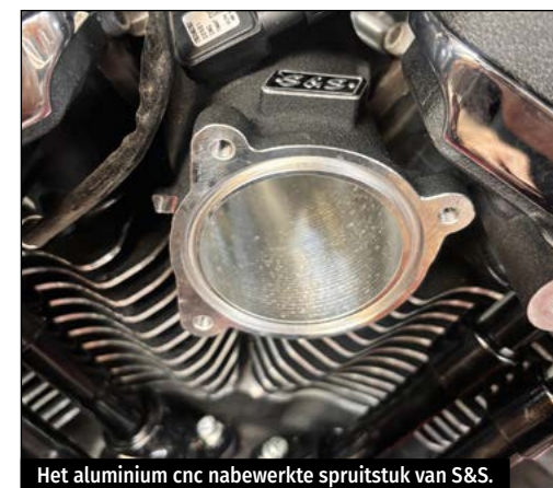
Het aluminium cnc nabewerkte spruitstuk van S&S.
