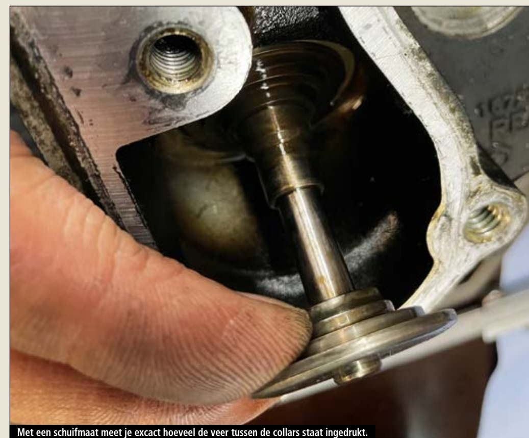
Met een schuifmaat meet je exact hoeveel de veer tussen de collars staat ingedrukt.
