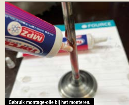
Gebruik montage-olie bij het monteren.
