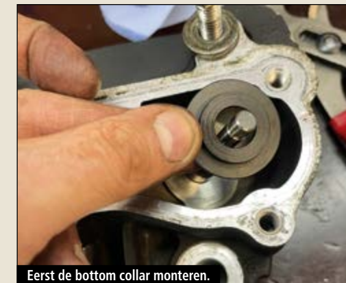
Eerst de bottom collar monteren.
