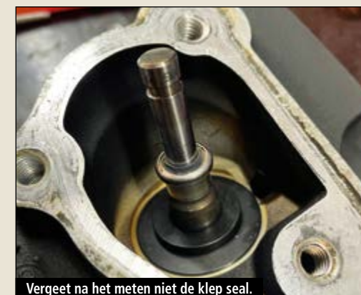
Vergeet na het meten niet de klep seal.
