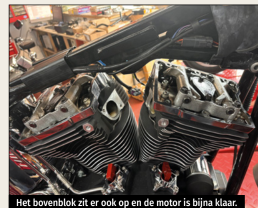
Het bovenblok zit er ook op en de motor is bijna klaar.
