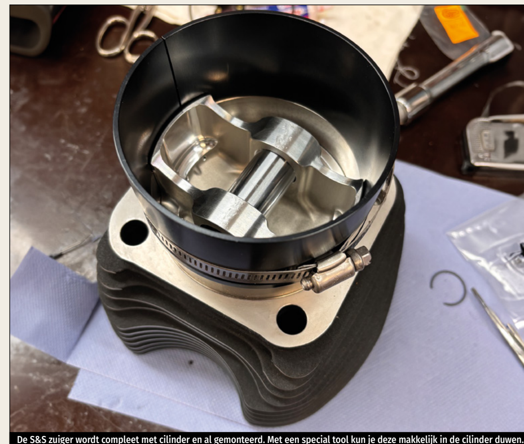
De S&S zuiger wordt compleet met cilinder en al gemonteerd. Met een special tool kun je deze makkelijk in de cilinder duwen.
