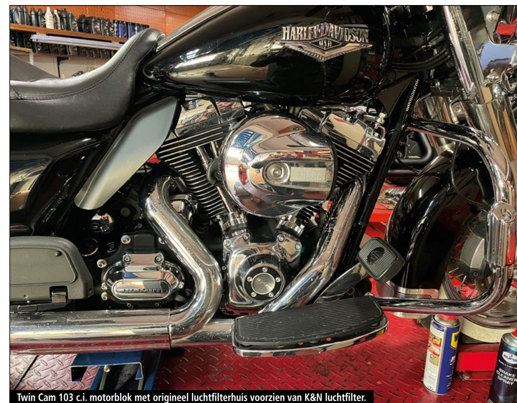
Twin Cam 103 c.i. motorblok met origineel luchtfilterhuis voorzien van K&N luchtfilter.
