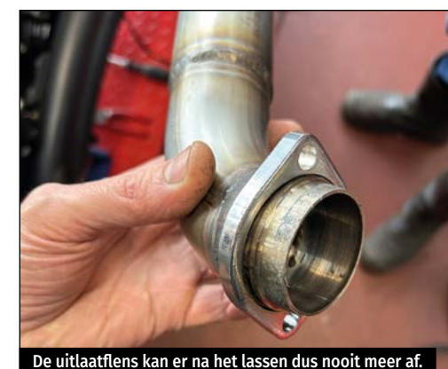
De uitlaatflens kan er na het lassen dus nooit meer af.
