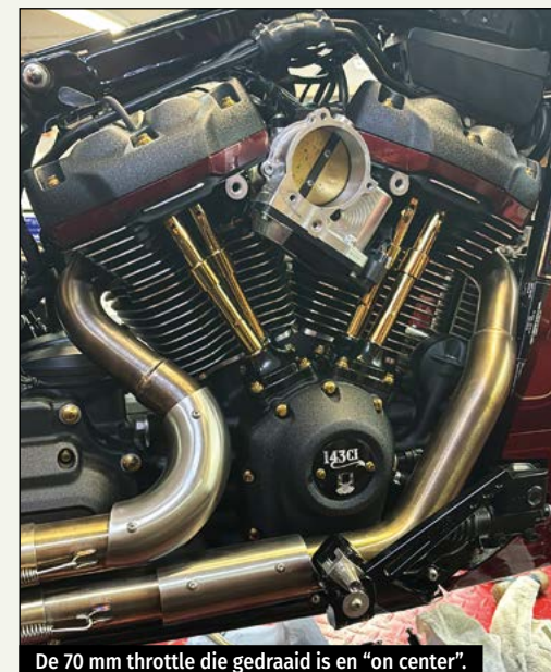
De 70 mm throttle die gedraaid is en “on center”.
