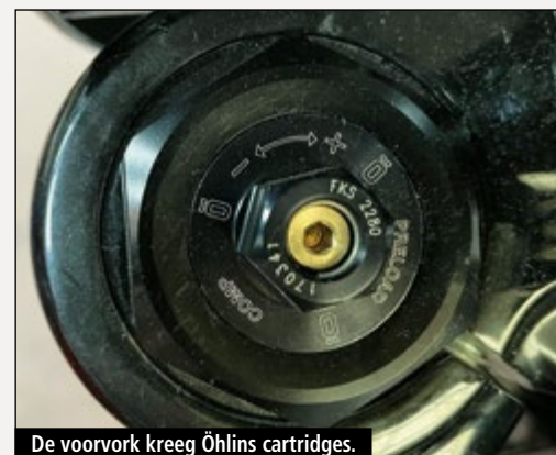
De voorvork kreeg Öhlins cartridges.
