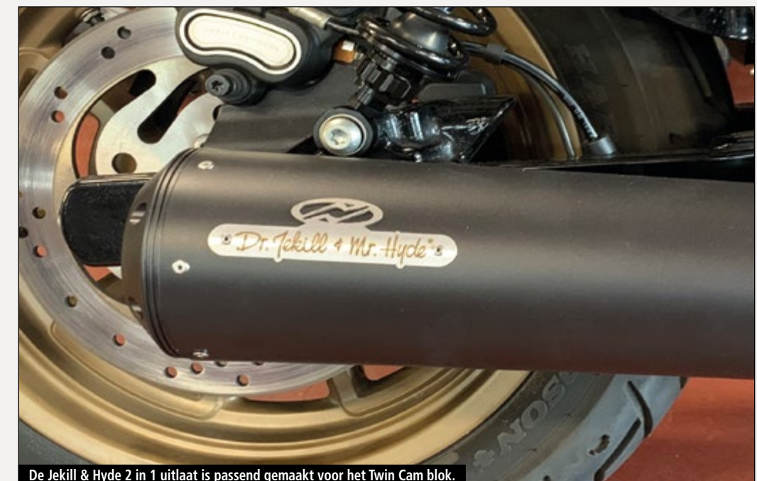
De Jekill & Hyde 2 in 1 uitlaat is passend gemaakt voor het Twin Cam blok.
