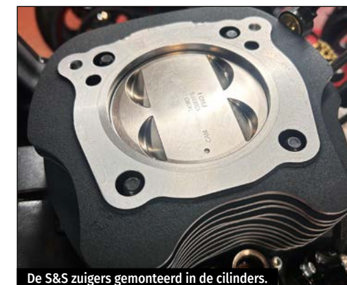
De S&S zuigers gemonteerd in de cilinders.
