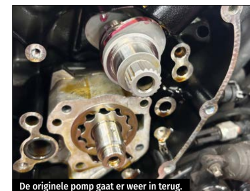
De originele pomp gaat er weer in terug.
