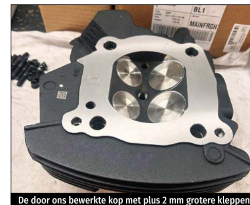
De door ons bewerkte kop met plus 2 mm grotere kleppen.
