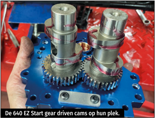
De 640 EZ Start gear driven cams op hun plek.
