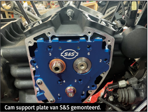
Cam support plate van S&S gemonteerd.
