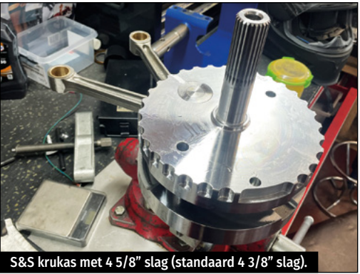
S&S krukas met 4 5/8" slag (standaard 4 3/8" slag).
