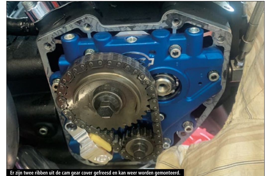
Er zijn twee ribben uit de cam gear cover gefreesd en kan weer worden gemonteerd.
