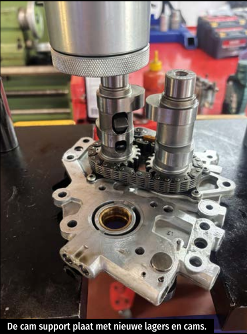
De cam support plaat met nieuwe lagers en cams.
