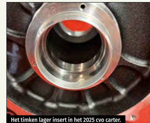
Het timken lager insert in het 2025 cvo carter.
