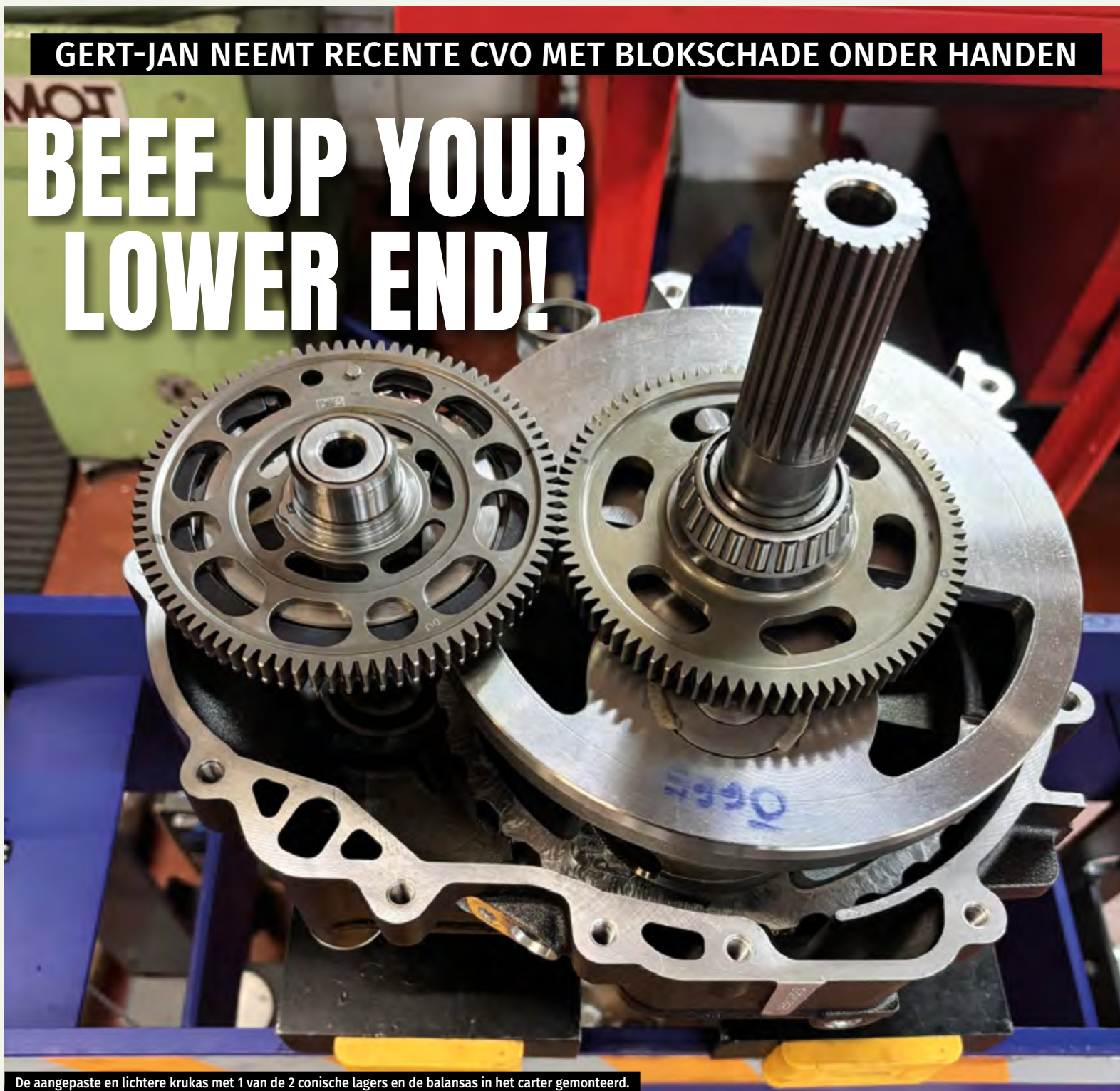
De aangepaste en lichtere krukas met 1 van de 2 conische lagers en de balansas in het carter gemonteerd.
