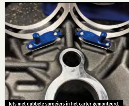
Jets met dubbele sproeiers in het carter gemonteerd.
