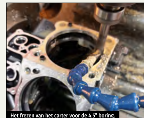
Het frezen van het carter voor de 4.5" boring.
